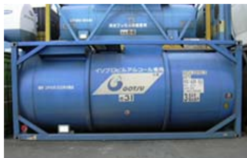
ISO規格に準拠した20ftタンクコンテナ
